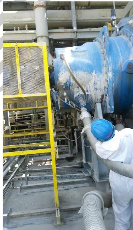
de MAQUINSA verificaran los equipos a intervenir, observan los accesos de por dónde circularan, mantendrán distancia de equipos en movimiento, no retiraran las guardas sin antes realizar el bloqueo.
