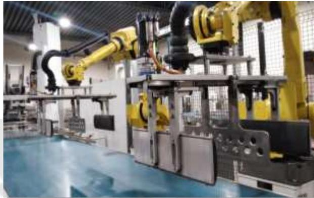
*Figura 18: Máquina Paletizadora Robot Fanuc.*
