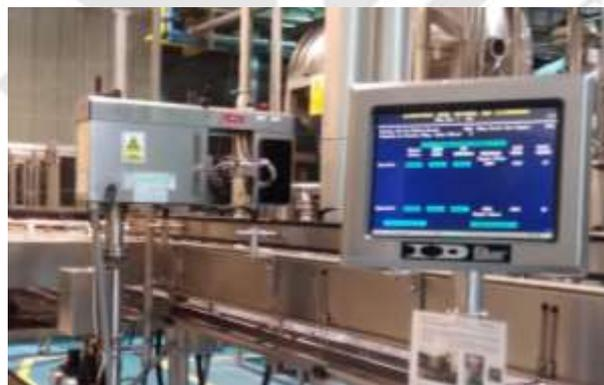
*Figura 15: Máquina Inspector Electrónico de Botellas.*
