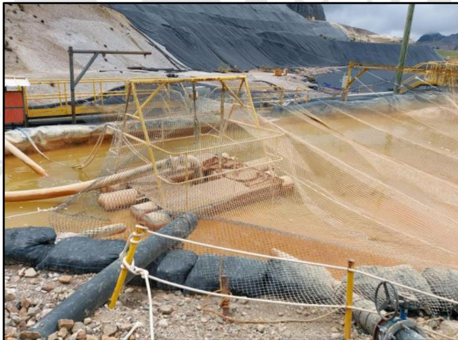
*Figura 9. Barcaza de soporte para la bomba León H-V3*
