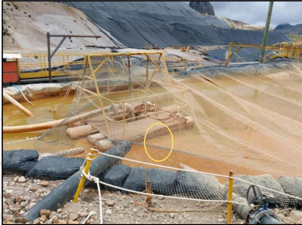
***Figura 14. Posición de la bomba después de la implementación de la barcaza***
