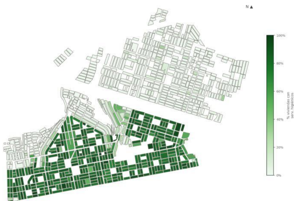
Figura 4. Acceso a servicios higiénicos por red pública en Alto Trujillo
