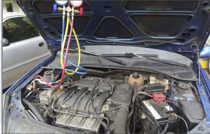
FIGURA N° 33: Sistema de Recarga de A/C
