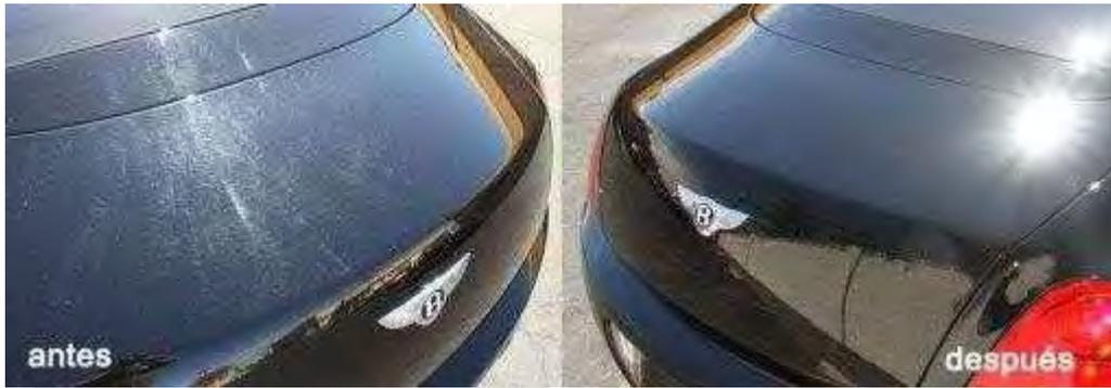
**FIGURA N° 31: Comparativa de una Superficie de Carrocería Antes y Después de ser Pulida.**
