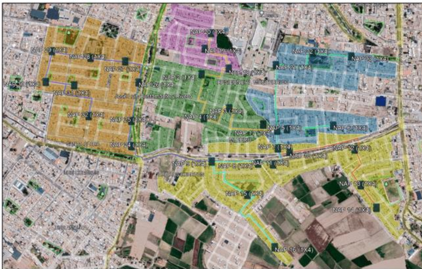
Figura 71. Trayectoria de la fibra óptica-Nivel Distribución
