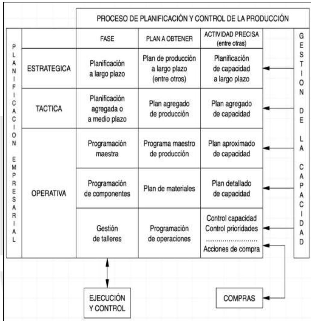
Fig. 10.- *Proceso de Planificación y Control de la Producción*
